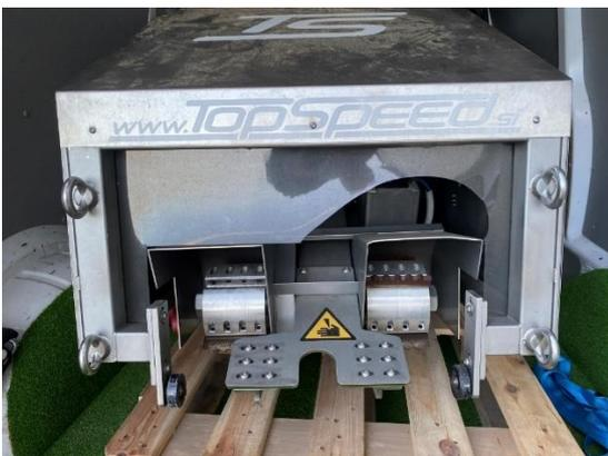
Eisfräse mit Fräskopf ohne Sicherungssystem mit Durchschlagskraft
