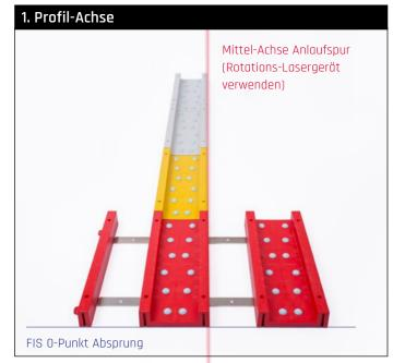
**2. Spur-Elemente:** Alle Elemente der Spur sind farblich gekennzeichnet. Beginnen Sie am Absprung mit den Elementen der Sommerspur, rot, gelb, grau.
