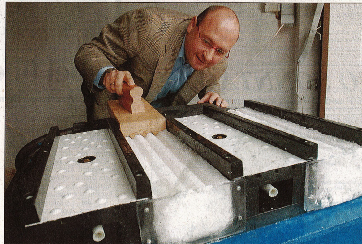
Peter Riedel aus Tellerhäuser mit einem Modul seiner kombinierten Anlaufspur. Zwei Rinnen sind vereist, die anderen beiden können mit Keramik, Glas oder anderen Materialien belegt werden.
